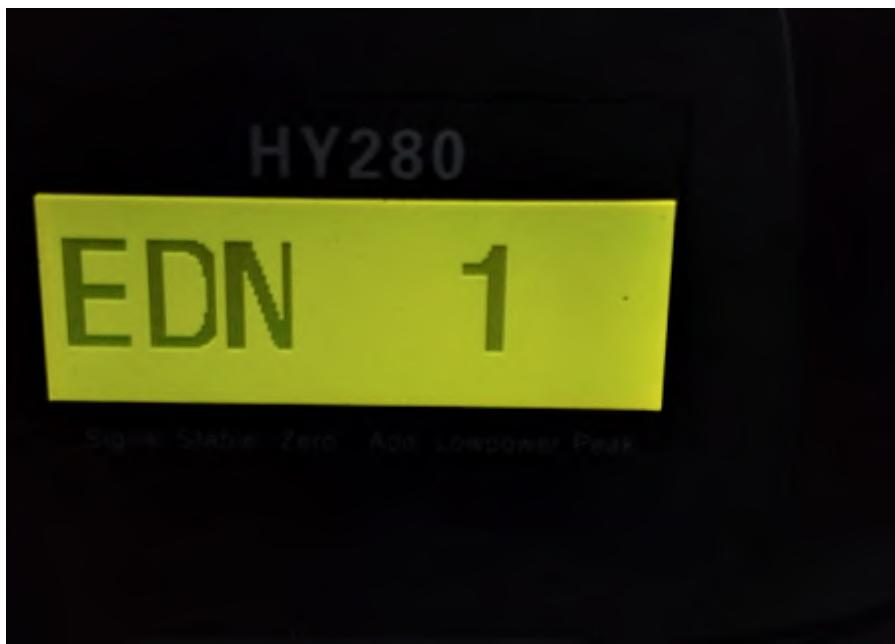
Select END 选择EDN 1: The supporting dynamometer mode 配套测力计模式
